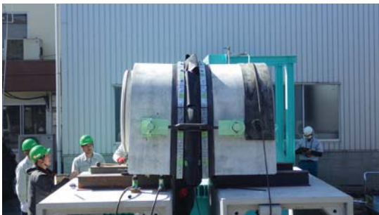
写真 22 屈曲状態（拘束部）試験状況
