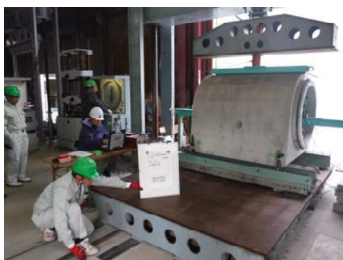
写真 11 ブロック性能確認試験状況変
