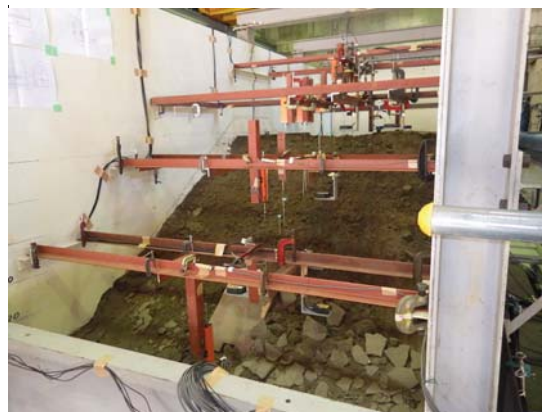
写真 28 400gal 加振完了後
