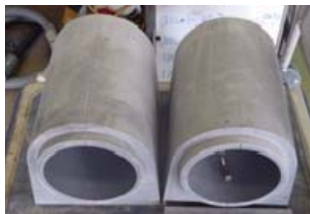
写真24 底樋ブロック
