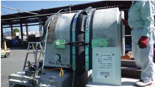
写真 20 抜け出し状態（拘束部）試験状況
