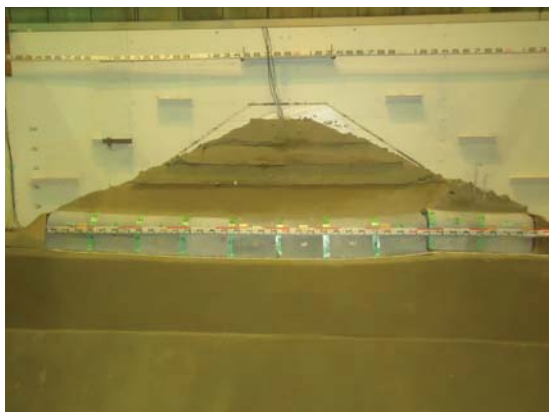
写真 29 堤体カット後の状況
