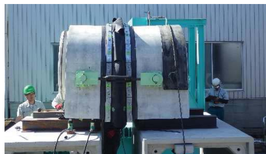
写真 8 屈曲状態（拘束部）試験状況
