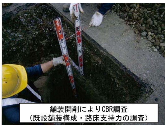
農道の点検診断を実施した現場 (既設舗装の状況)
