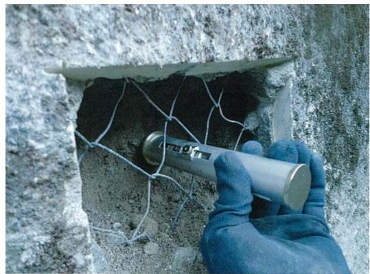
対象法面にロープで2.5m×2.5mのメッシュを作成し、目視によるクラック等変状調査、打音調査、背面状況調査を行い、損傷図作成を行った。
