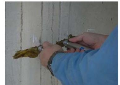
超音波ひび割れ深さ測定状況
