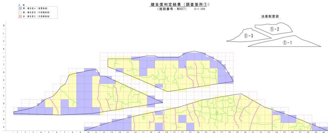
調査結果から図書「老朽化吹付け法面の調査・対策の手引き（（財）物理探査学会）」を参考に、①吹付材料の劣化度、②背面地山との密着性、③湧水・植生状態、④亀裂・ずれ等その他の変状の4項目から総合的に健全度評価を行い、対策工法選定の基礎資料とした。
