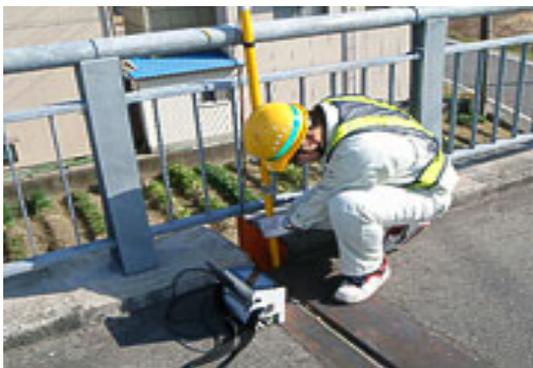
モニターカメラによる上部工点検
