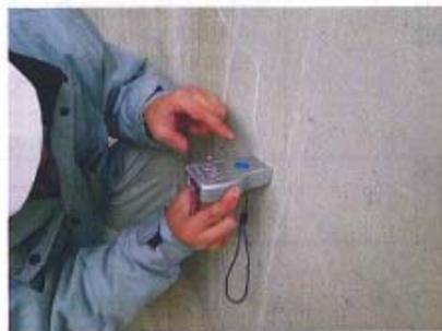
ひび割れ幅測定状況
