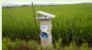
自動給水栓による省力化
