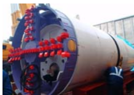
左岸幹線用水路 (シールドマシン)
