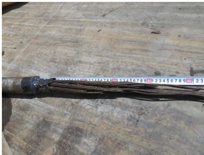
図 2-9 テンドンの破断状況
