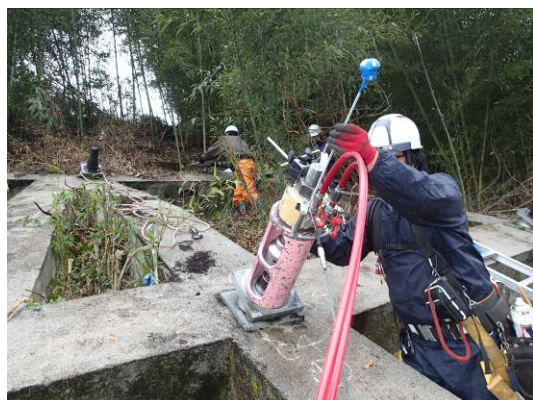
図 4-4 リフトオフ試験 (小型軽量ジャッキ使用)
