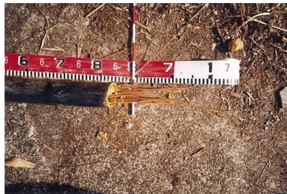
図 2-26 テンダンの腐食の事例
