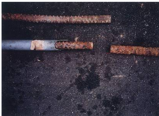
図 2-26 テンダンの腐食の事例
