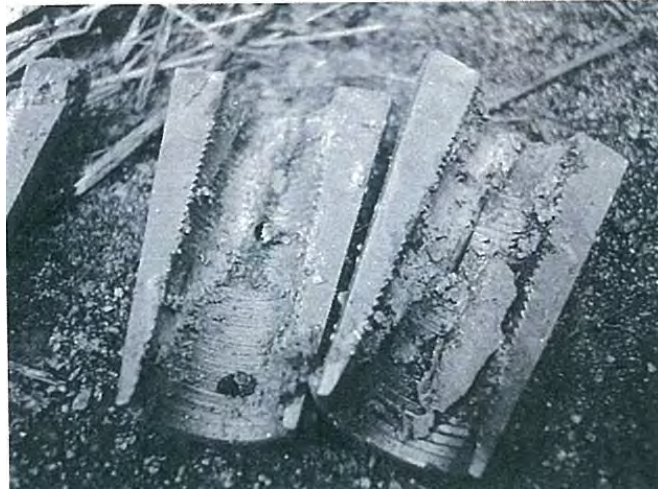
図 2-25 くさび劣化の事例
