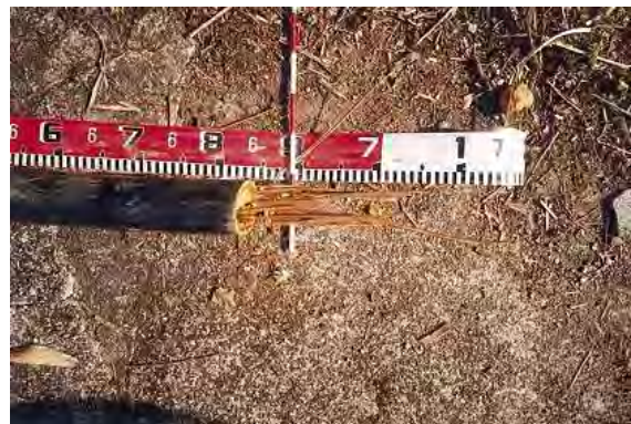
図 2-26 tendon の腐食の事例
