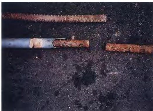
図 2-26 tendon の腐食の事例
