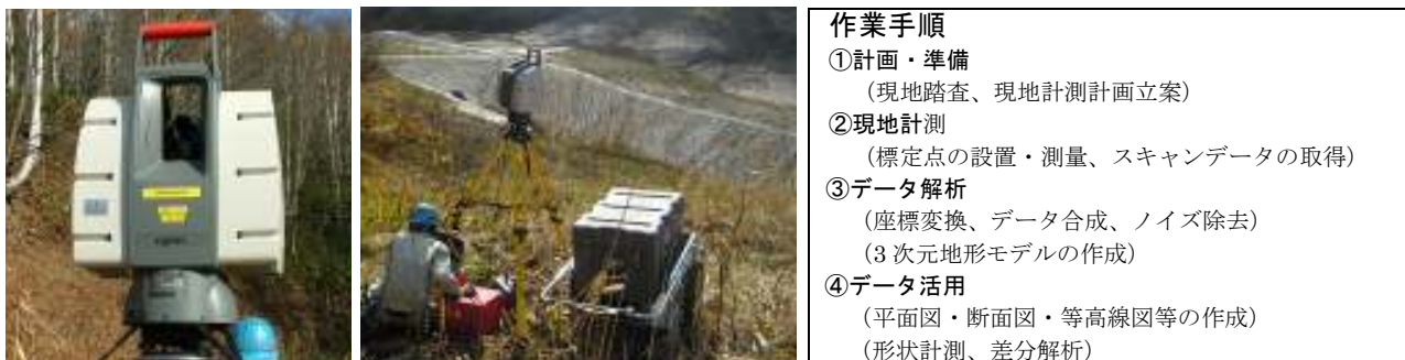
図-5.3.4 LP 計測の状況と作業手順
