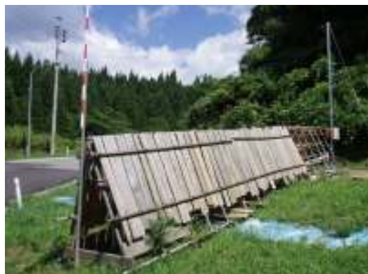
写真-5.4.2 地表伸縮計の雪囲い例
