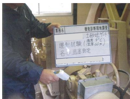
写真 5.2 レーザー付き非接触温度計による計測例
