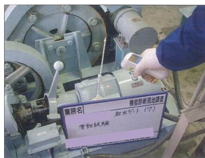
写真 5.2 レーザー付き非接触温度計による計測例
