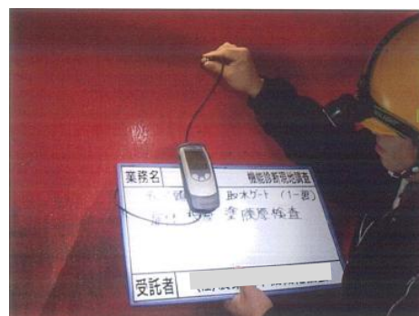
写真 3.2 電磁渦電流膜厚計による測定例
