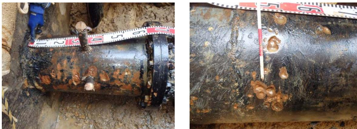
図 2.4-1 メタルタッチに伴う C/S マクロセル腐食例
