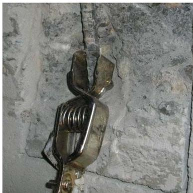
図 3.3-14 鉄筋からの測定端子取り出し例
