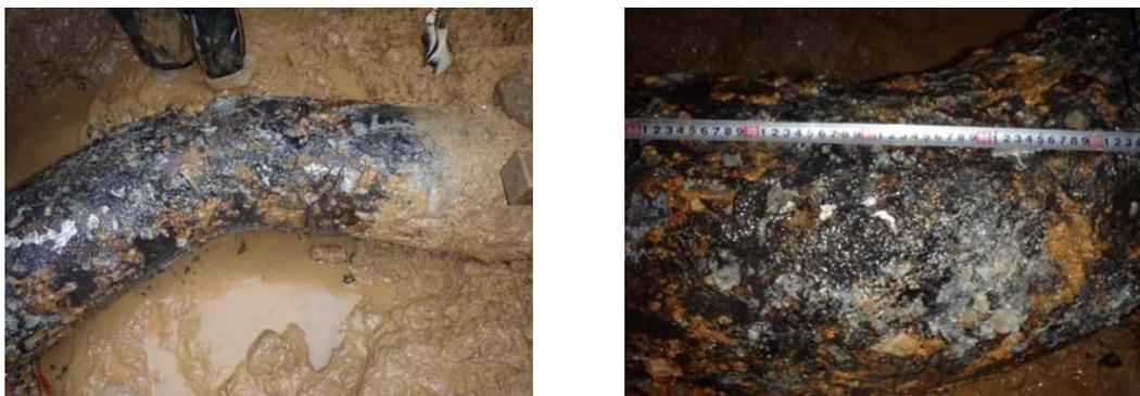
図 1.1-7 石礫等を含んだ埋戻し土の転圧による塗覆装の損傷例
