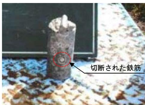
図 4.3-32 鉄筋切断状況例
