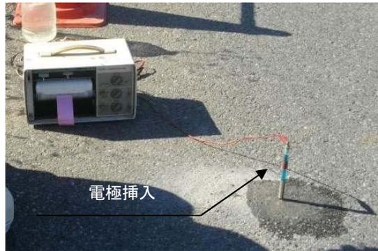
図 3.3-7 舗装道路上の照合電極配置例
