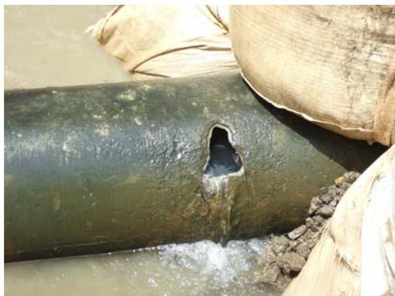
図 1.2-2 断面欠損が生じたダクタイル鋳鉄管の例
