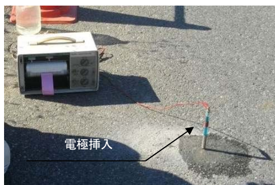
図 3.3-7 舗装道路上の照合電極配置例
