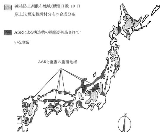
図 3.3-19 ASR<sup>1)</sup>と塩害による複合劣化の可能性がある地域
