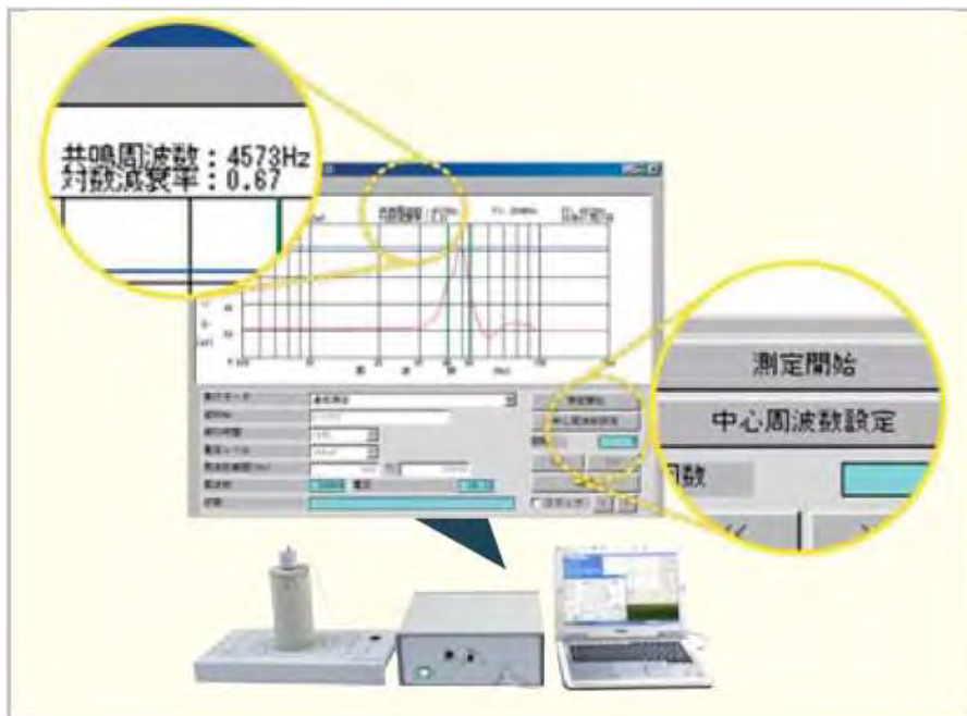
【パソコン画面上でリサージュ表示するシステムの例】
