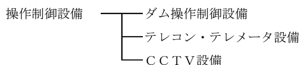
図-10.18 操作・制御設備の分類
