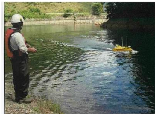
リモコンボート操作による堆砂測量
