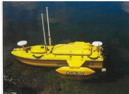
発信機とGPSアンテナ（白色円盤状のもの）を搭載したリモコンボート
