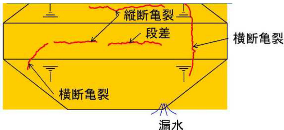
図-9.7 地震により発生する変状（亀裂・漏水等）
