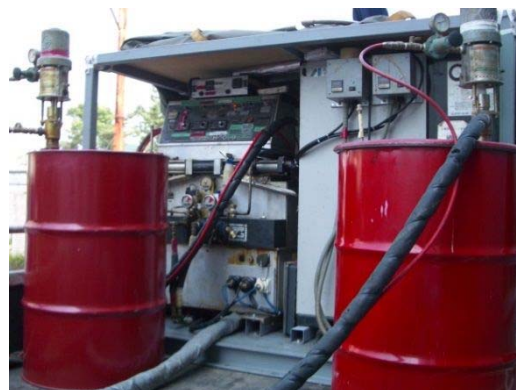
写真 5. 2-8 吹付け用専用塗装機（例）
