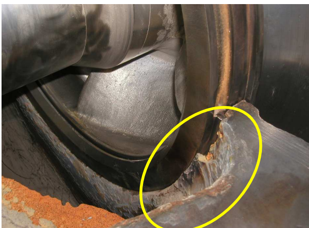
（e）ライナリング設置溝の損傷 （ライナリングの設置が安定しない）
