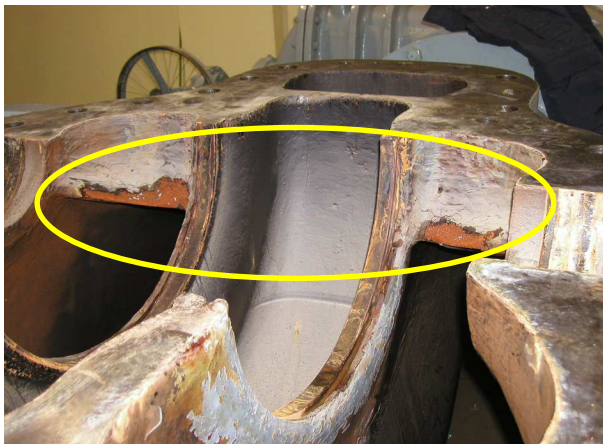
（c）旋回流防止板部のエロージョン（壊食）
