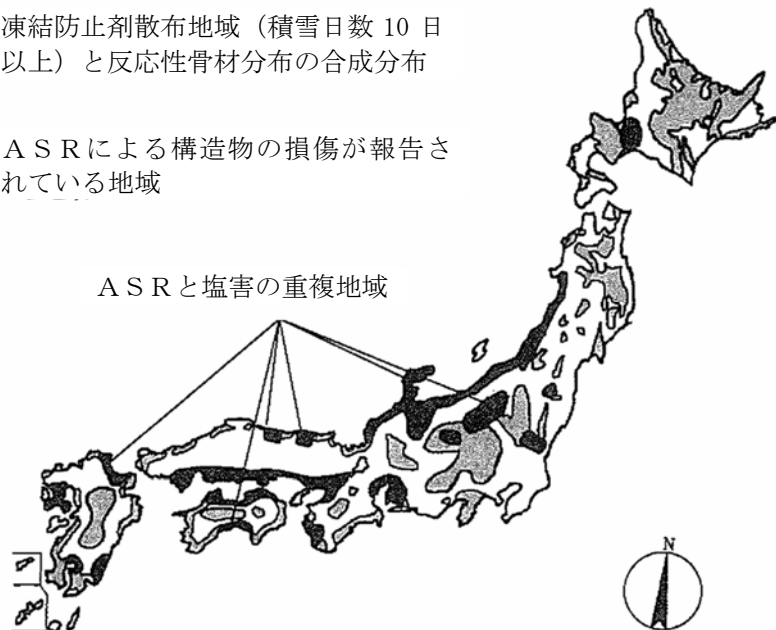
図-2.5.5 ASRと塩害による複合劣化の可能性のある地域
