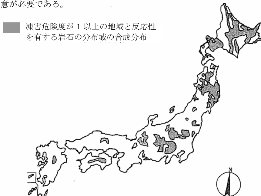
図-2.5.7 凍害とA S Rの複合劣化の可能性がある地域
