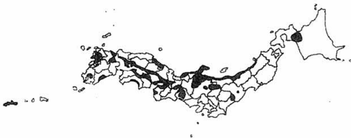
図-2.5.3 ASRによる損傷が報告されている地域
