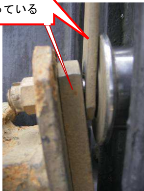
写真-9.1.4 レーキチェーンの変形例
