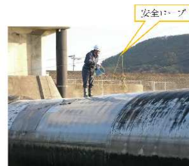
例；石鹸水散布による確認状況
