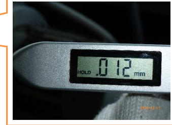
振動計による電動機の振動測定状況
