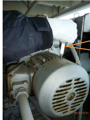
振動計による電動機の振動測定状況
