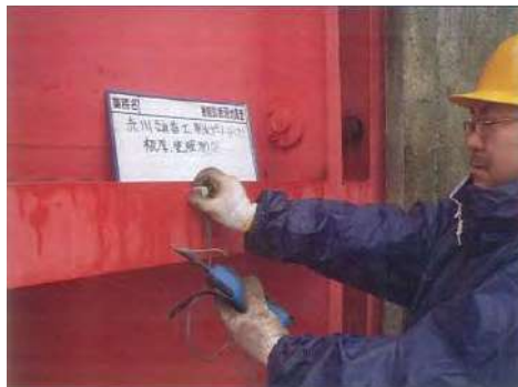
図 5.3.17 電磁渦電流膜厚計による測定例
