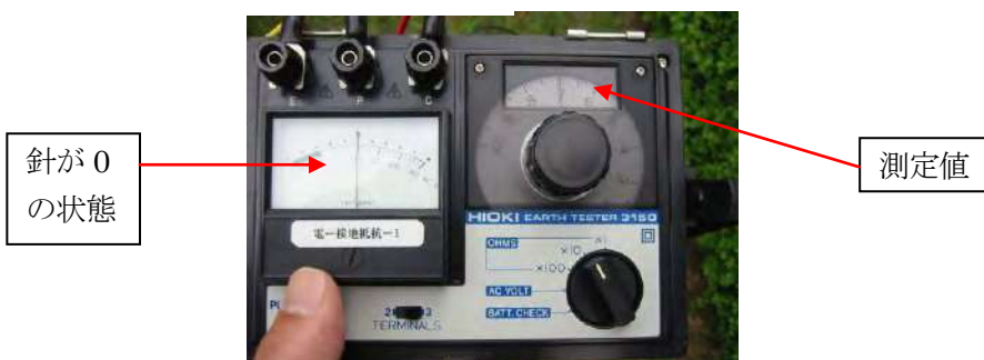
針が0状態のダイヤル数値が測定値となる (写真では接地抵抗値は、約 70\Omega )
