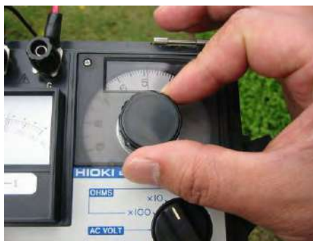
ダイヤルを回し、針を0に合わせる
