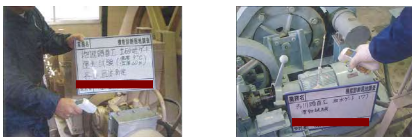
図 5.3.24 レーザー付き非接触温度計による計測例
