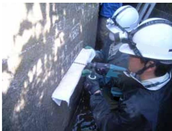
写真-3.2.77 ドリル法による中性化試験
