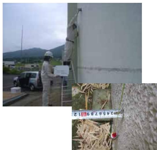
図-3.2.46 下げ振りをを用いたファームポンドの変形測定
