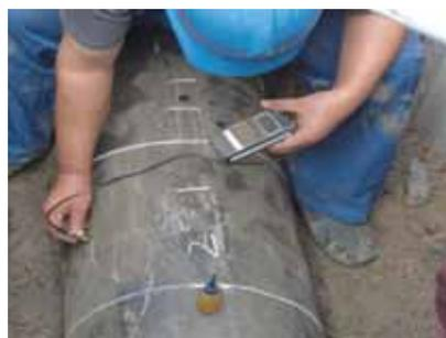
写真-3.2.90 腐食深さ (左)・管厚 (右) の測定例
