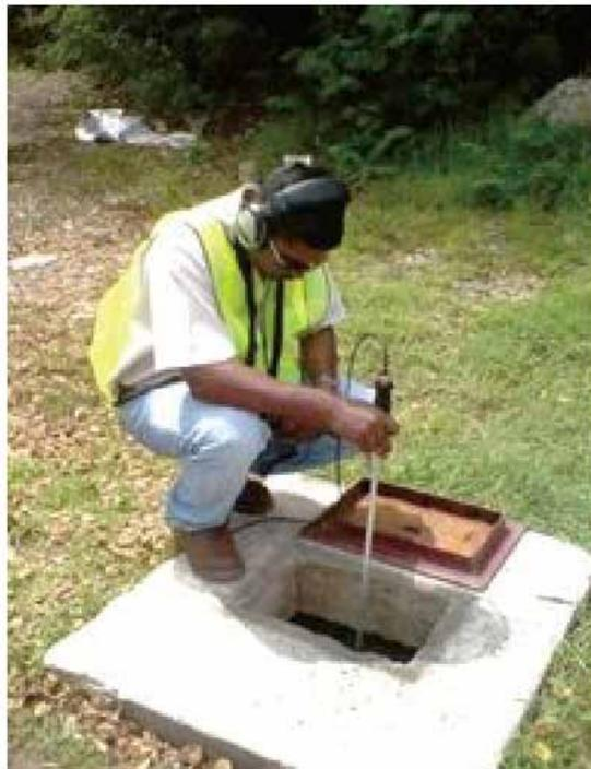
図-3. 2. 51 漏水探査機の例
