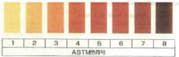
簡易比色法によるASTM規格の色見本
