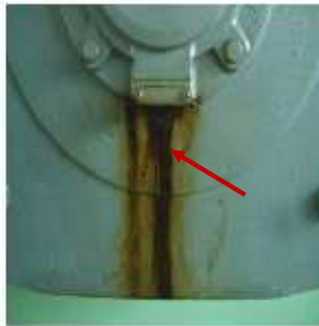
電動機の軸受部の油漏れ（漏れた跡、にじんでいる）
