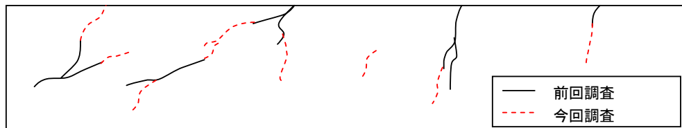
図-2.2.28 ひび割れの進行性
