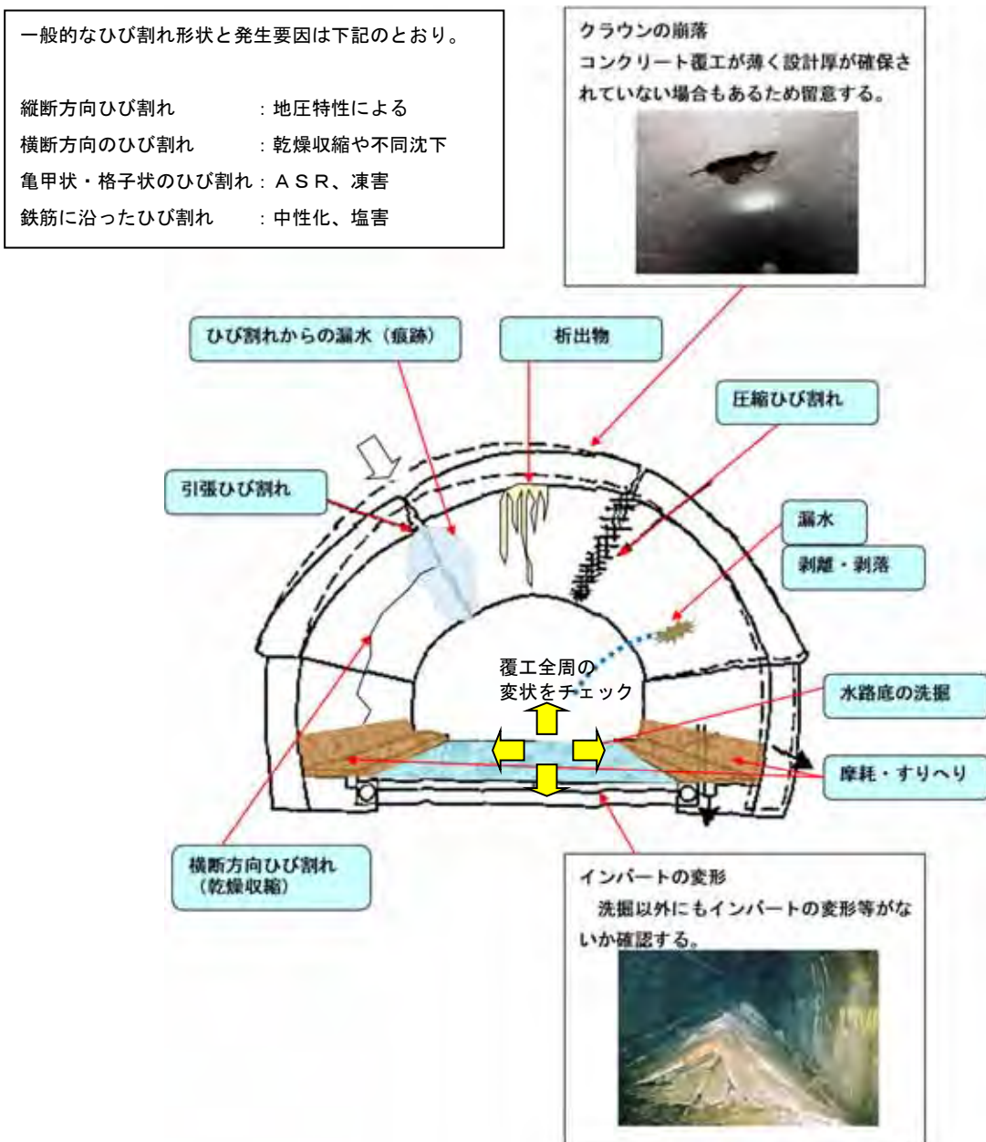
図-2.2.10 水路トンネルの調査のポイント
