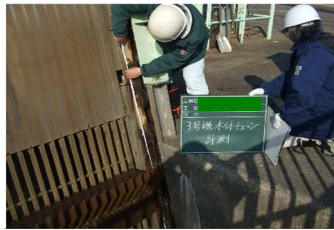
写真-9.2.12 レーキチェーンの伸び測定例
