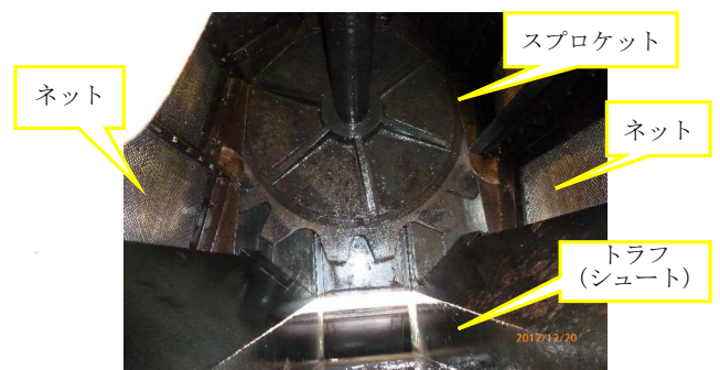
ネット形除塵機内部構造例
