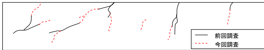
図-4.2.19 ひび割れの進行性
