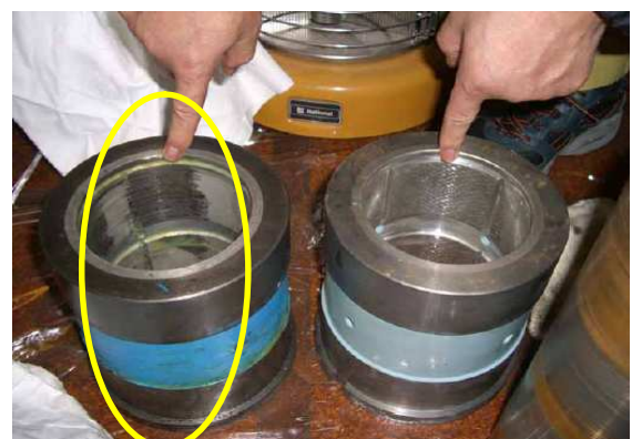
(e) 新旧の水中軸受 (左が旧の潤滑溝が摩滅している水中軸受)
