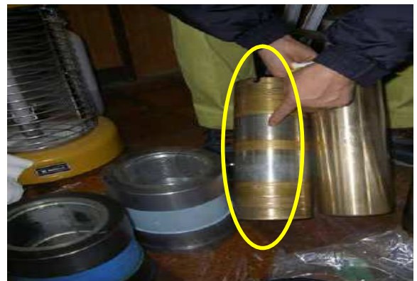
(d) 新旧の水中軸受スリーブ (左が摩耗している旧のスリーブ)
