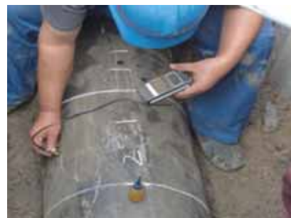
写真-3.2.90 腐食深さ（左）・管厚（右）の測定例
