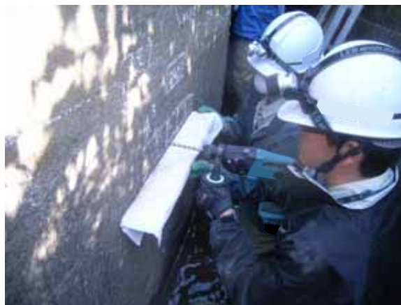
写真-3. 2. 77 ドリル法による中性化試験
