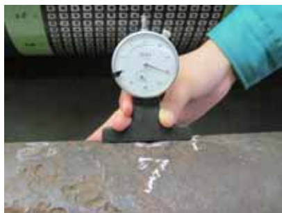
写真-3.2.90 腐食深さ（左）・管厚（右）の測定例
