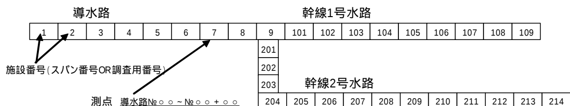
図-3.2.6 スパン番号等の記録例（管内での管内徒歩巡回目視の場合）
