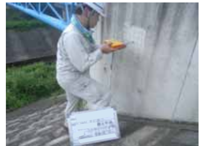
写真-3.2.58 リバウンドハンマー試験
