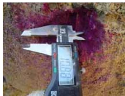
写真-3.2.91 管外面の状態確認（左）・中性化深さ計測（右）の例
