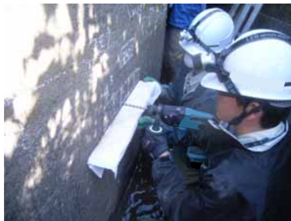
写真-3.2.61 ドリル法による中性化試験
