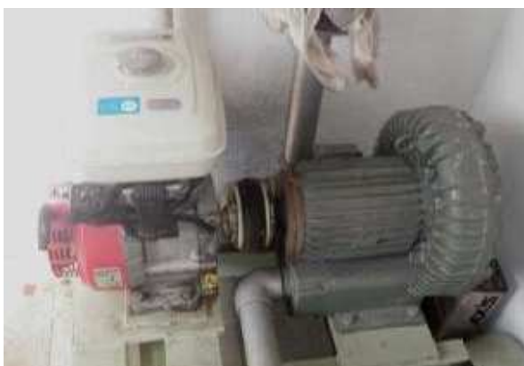
写真-7.1.16 エンジン、ブローの振動対象装置の例
