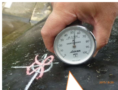
硬度計を押し付けると、沈んで正しい値よりも小さい値となる。
