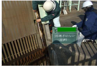
写真-9.2.12 レーキチェーンの伸び測定例
