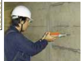
写真-1.2.16 リバウンドハンマー試験
