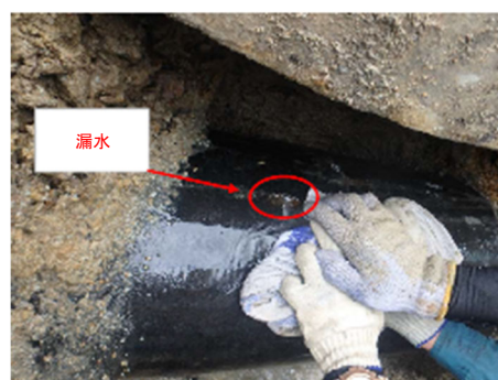
【写真4-5 DCIP（C/Sマクロセル腐食）】
