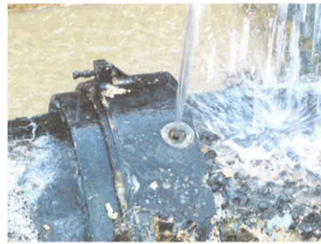
写真 8 C/Sマクロセル腐食 (SP)
