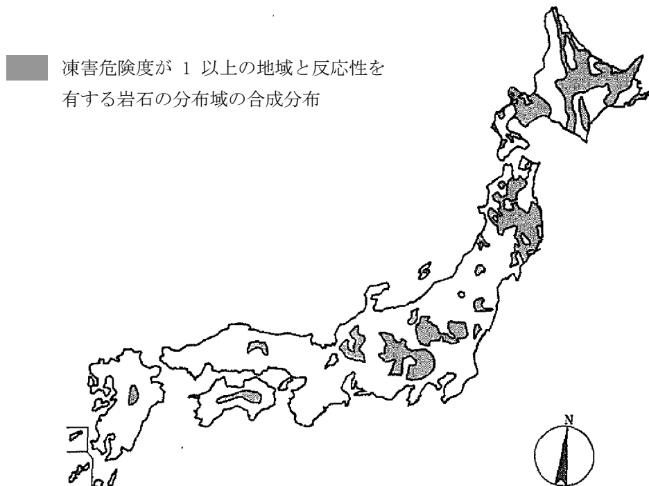
図 1.2.7 凍害と ASR の複合劣化の可能性がある地域
