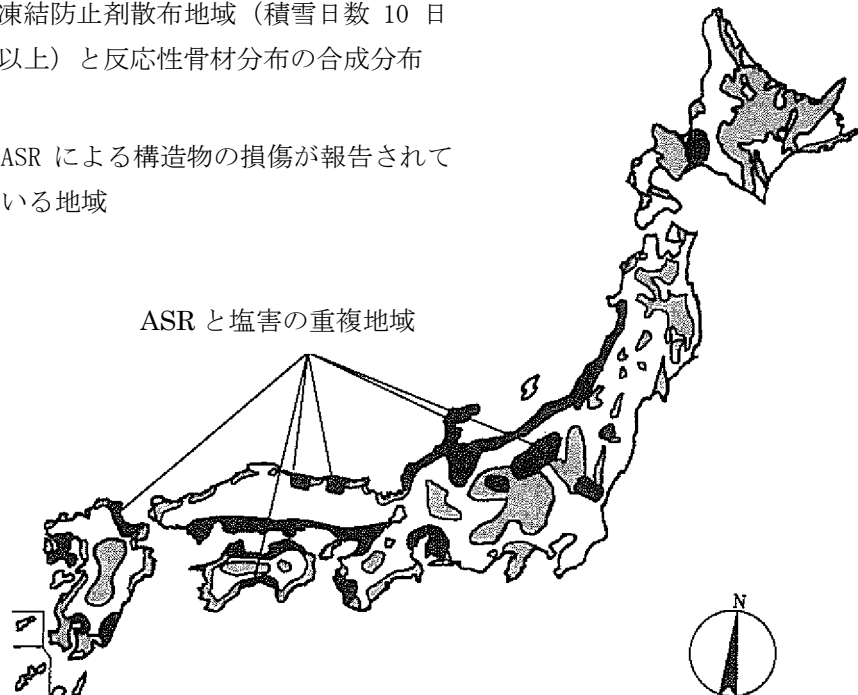
図 1.2.5 ASR と塩害による複合劣化の可能性のある地域
