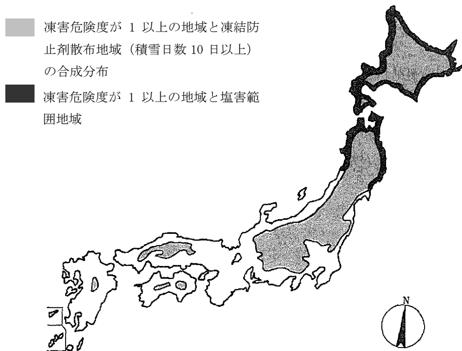
図 1.2.6 塩害と凍害による複合劣化の可能性がある地域
