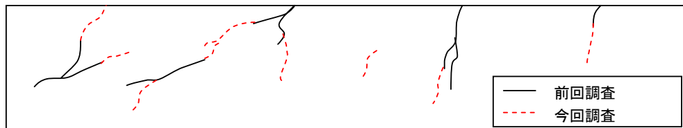
図-1.2.26 ひび割れの進行性
