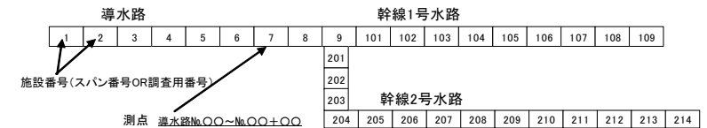
【管内部の現地踏査を行う場合の位置出し事例】
