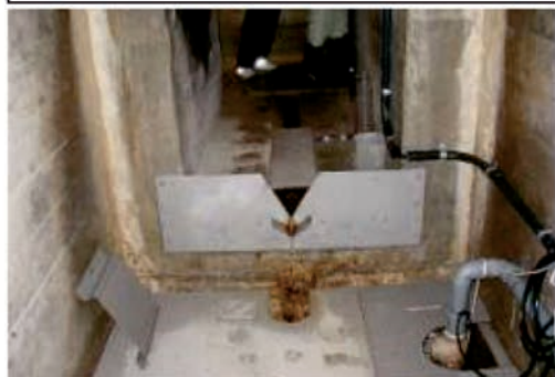
浸透量計測施設(三角堰) [緊急報告]
