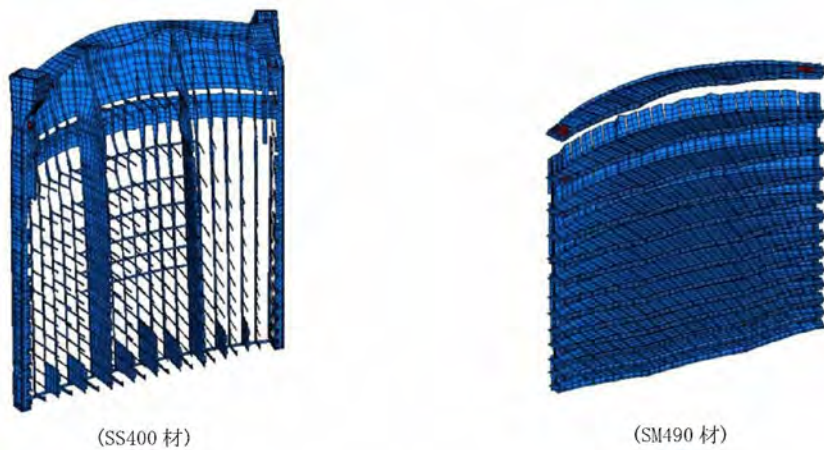
図 6.1.3-23 ゲートの合成応力分布（上流最大変位時 14.29s）
