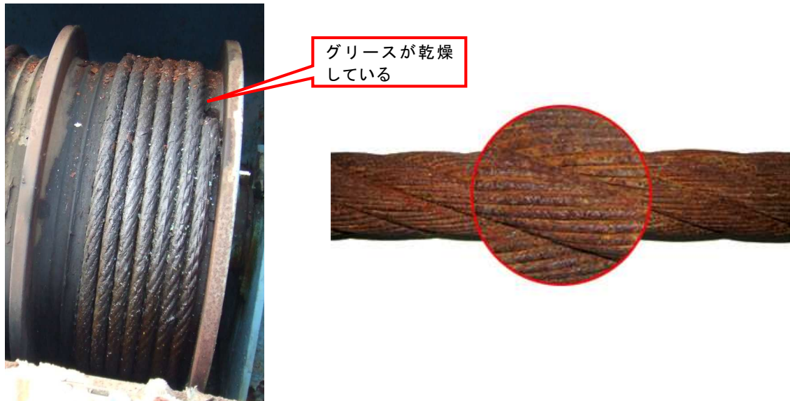
写真-6.1.19 ワイヤロープの給油不足の例（左）及び腐食の例（右）
