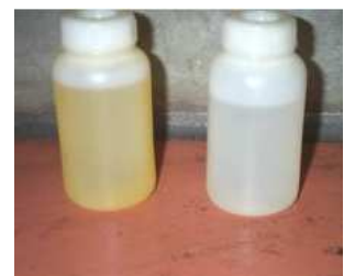
変圧器の絶縁油の劣化油と新油
