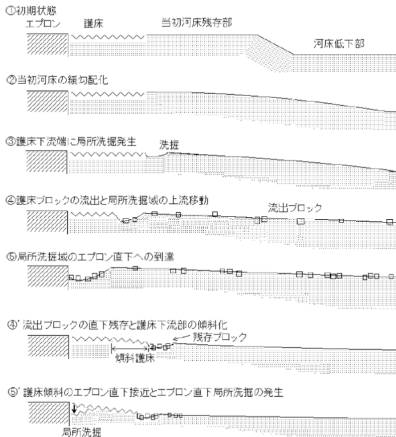
図-4.2.6 下流河床低下での護床工変形パターン模式図
