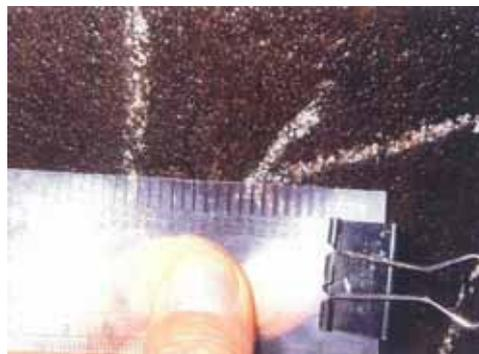
写真-3.2.19 クラックスケールによる測定
