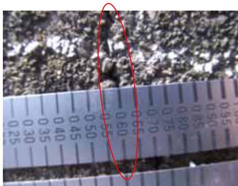
写真-3. 2. 48 ひび割れ幅計測
