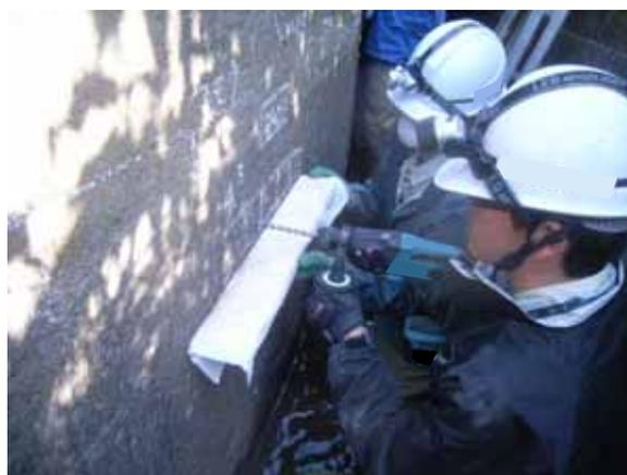
写真-3.2.61 ドリル法による中性化試験
