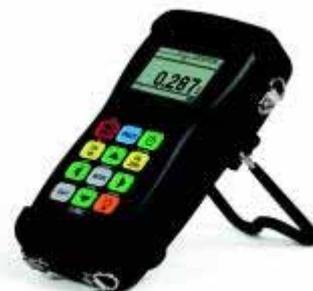
写真-3.2.37 超音波厚さ計の例
