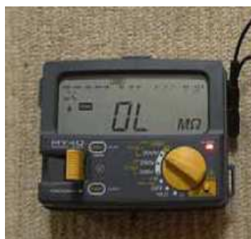
絶縁抵抗測定 NO.2 ポンプ U-E間 OL (2000MΩを超えた場合の表示)
