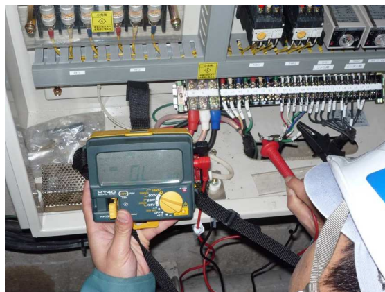
絶縁抵抗測定 NO.2 ポンプ U-E間 OL (2000MΩを超えた場合の表示)
