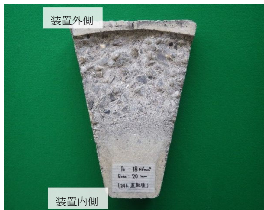
図4 促進摩耗試験後の供試体
