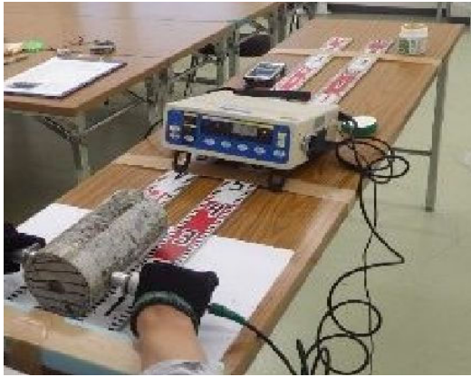
写真 6. 6-2 透過法の試験状況
