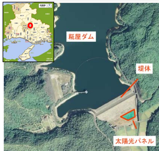
糞屋ダム堤体下の広場を利用した太陽光発電施設
