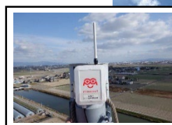
無線基地局(LPWA)は携帯電話基地局の中に設置 見通しがよく1台で広い範囲をカバー
