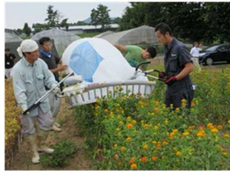
写真 26 改良した茶摘み機（試作） による収穫試験
